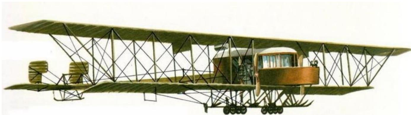
Самолет представлял собой четырехмоторный биплан. Фюзеляж самолета имел прямоугольную деревянную конструкцию. Крылья самолета были обтянуты фанерой. На нижнем крыле установлены 4 двигателя по 100 л.с. Перед капитанской рубкой находилась открытая площадка, в которой должны были устанавливаться прожектор и пулемет.
